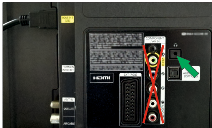
Beispiel Bild: 3,5mm Stereo-Klinke Kopfhörer-Ausgang (grüner Pfeil). Reine Eingänge wie hier die durchgestrichenen Component / AV IN Buchsen eignen sich NICHT. Nur Audio Buchsen die mit OUT oder Ausgang beschriftet sind, geben auch ein Tonsignal aus. Ggf. benötigst Du dafür dann ein passendes Adapterkabel auf einen 3,5mm Stereo-Klinke Stecker, der wiederum am SQ-AMP MK-II angeschlossen werden kann.
